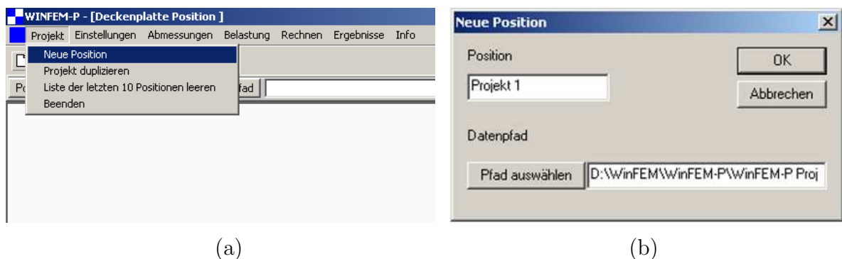
Abb. 2.1: a) In der Menüzzeile Projekt öffnen und Neue Position starten. b) Eingabefenster um die neue Position zu benennen und den Speicherort festzulegen.
