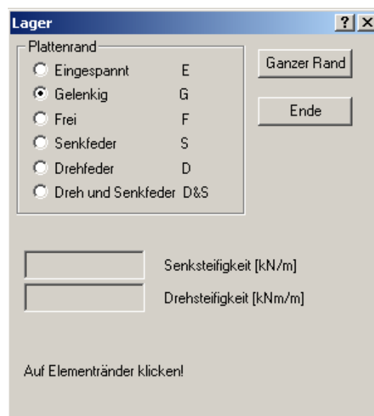
Abb. 2.5: Im Eingabefenster der Lager kann die entsprechende Lagerungsart gewählt werden.
