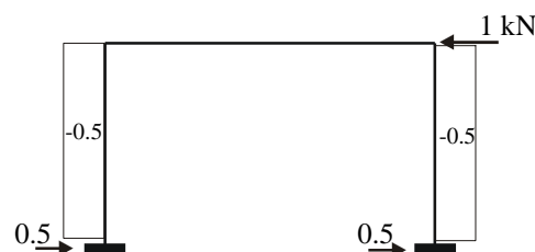
Abb. 6.5 Ersatzsystem mit exakten Querkraftverlauf in den Stielen
